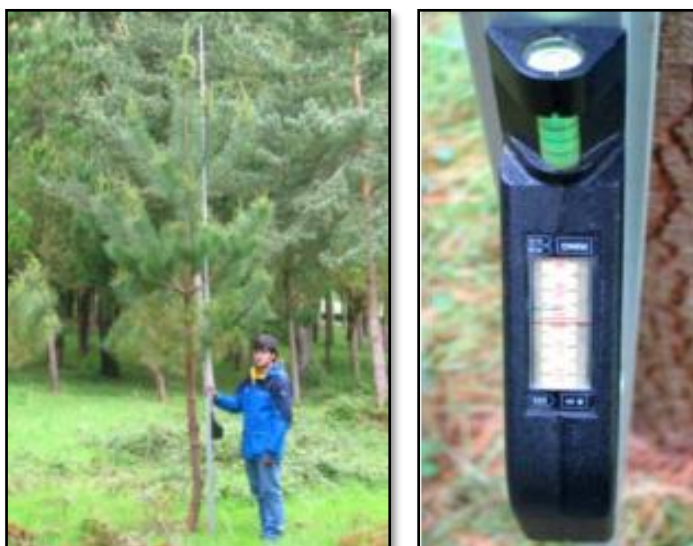
Figura 6. Misura dell'altezza totale con l'asta telescópica (sinistra) e dettaglio del lettore dell'asta telescópica (destra). Fonte: Diéguez-Aranda, 2005.
